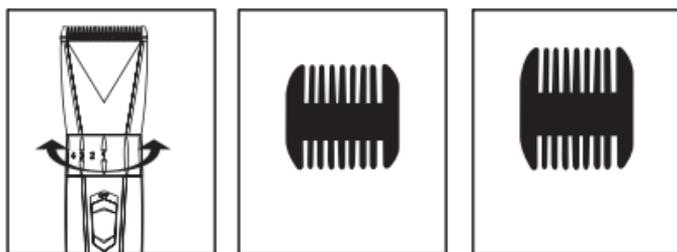
В комплекте с прибором поставляется 4 насадки разной величины: 3, 6, 9, 12 мм. Увеличение и уменьшение длины среза также можно регулировать специальным механизмом на корпусе машинки для стрижки. Засечки на кольце переключателя обозначают степень длины среза.
