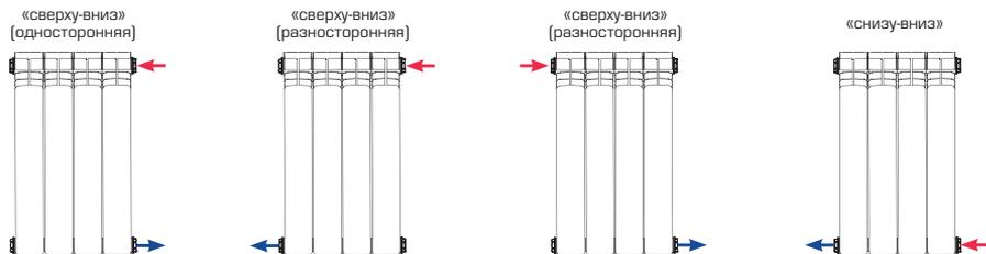
**В ВЕРХНЮЮ ПРОБКУ РАДИАТОРА ОБЯЗАТЕЛЬНО ДОЛЖЕН БЫТЬ УСТАНОВЛЕН ВОЗДУХОВЫПУСКНОЙ КРАН!**
