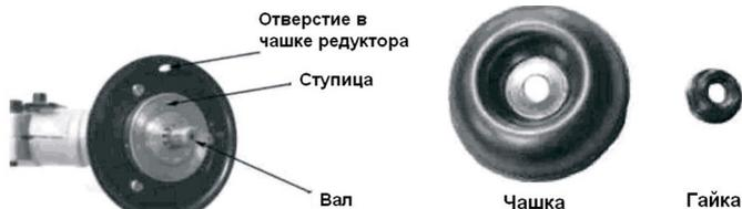
Установите режущий нож на ступицу. Убедитесь, что режущий нож правильно отцентрирован и лежит на проточке ступицы. Установите на вал чашку крепления.
